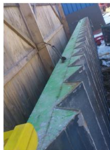
Moule pour escaliers à Fontenette
